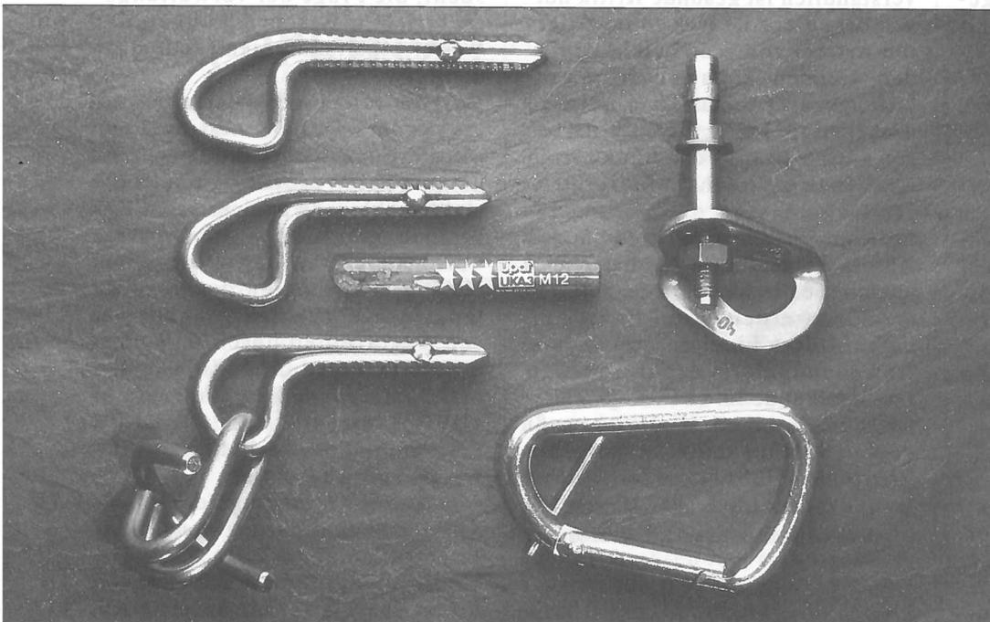
Das komplette Sortiment der OeAV-Sicherheitshaken inkl. Klebpatrone: Klebehaken (70 mm, 90 mm), Expansionshaken, Topropehaken und Topropekarabiner - alle aus VA4- Stahl, das heißt korrosions- und säurebeständig!
