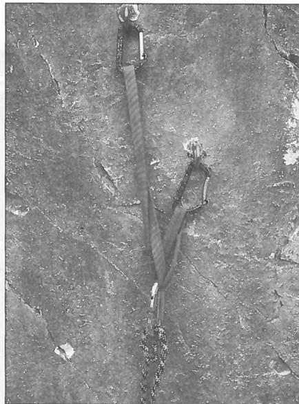
**Redundanz - trotz Klebehaken! Die neue Standplatzempfehlung: 2 Klebehaken, ca. 30 cm vertikal und ca. 10 cm horizontal versetzt. Zwischenhaken und Standhaken sind in Zukunft identisch.**
