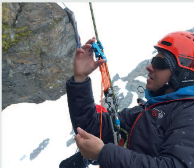
[RescYou] Das RescYou von Mammut ist ein Spaltenrettungsgerät bestehend aus einem 6fach-Flaschenzug und 2 Seilklemmen.
