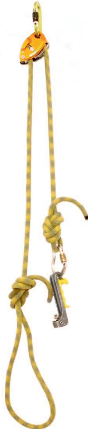
**Abb. 3** Die Entlastungskonstruktion besteht aus einer Seilbremse (hier Grigri), in welche ein Seilstück eingelegt wird, an dessen einem Ende eine Steigschleufe geknotet ist und an dessen anderem Ende eine Steigklemme fixiert ist (die Bremse blockiert bei Zug auf die Klemme).
